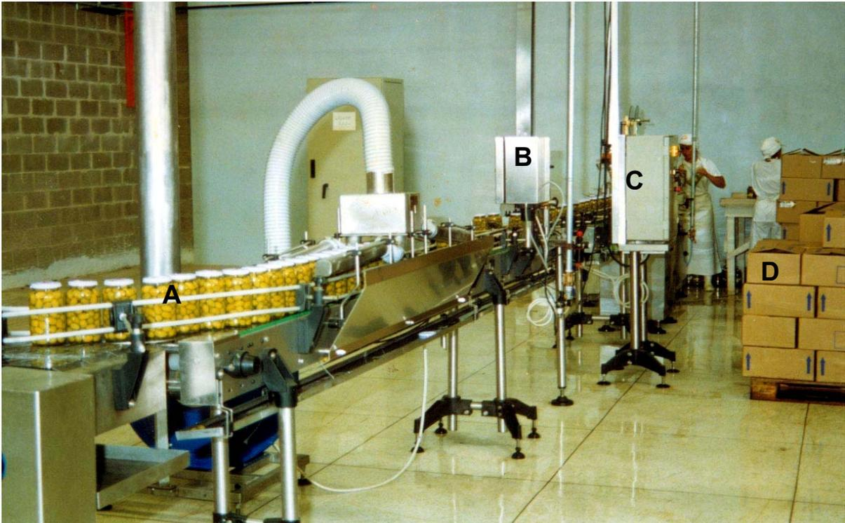
Figura 16: Foto parcial da máquina *Gherri*, se destaca (A) o frasco já pasteurizado, passando pelo processo de secagem, posteriormente passa pela datadeira (B) e a seguir pela rotuladeira (C), para inspeção final e encaixotamento (D).
