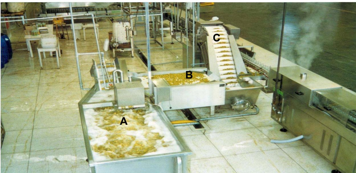
Figura 15: Foto com vista parcial da linha de produção do envase de azeitonas verdes, destacando-se em (A) tanque de lavagem, em (B) mesa para seleção das azeitonas, em (C) esteira rolante por elevação para transportar as azeitonas até a mesa niveladora para o envase.
